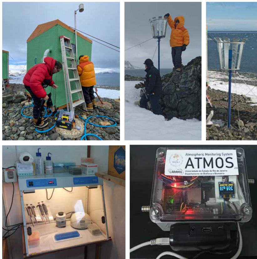
Fig 2. Primeiras atividades do CBPS-Uerj/INCT-Criosfera no Módulo Ipanema. Instalação de coletores de aerossóis e neve recente e infraestrutura para bioaerossóis.
